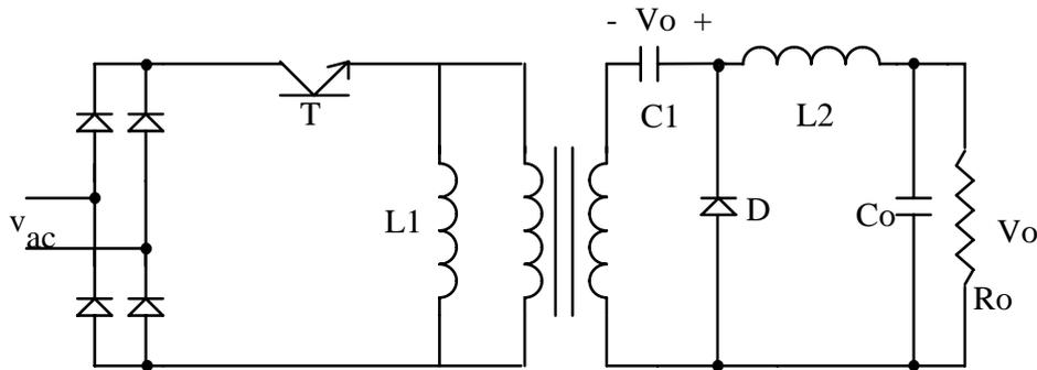
Figura 3.16 Conversor Zeta (isolado) como PFP.
