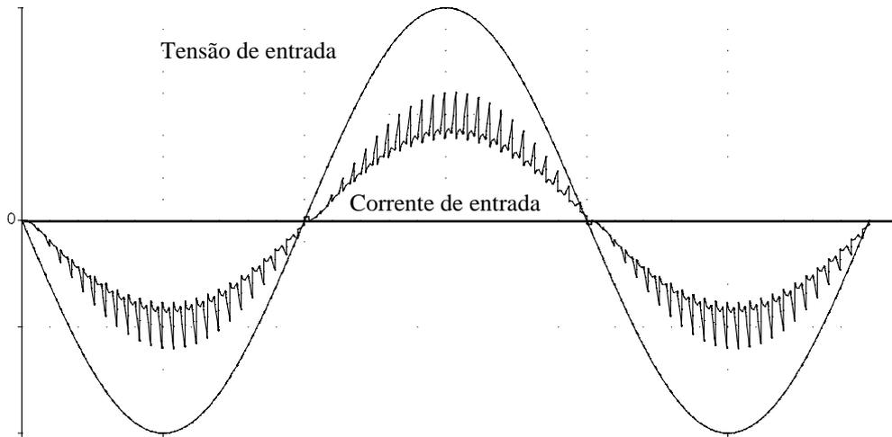
Figura 6.9 Corrente e tensão de entrada em conversor Cuk como PFP, em condução descontínua
