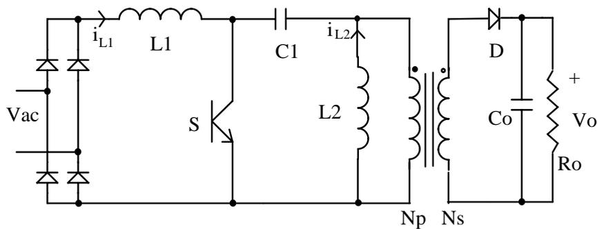
Figura 3.15 Conversor SEPIC isolado operando como PFP
