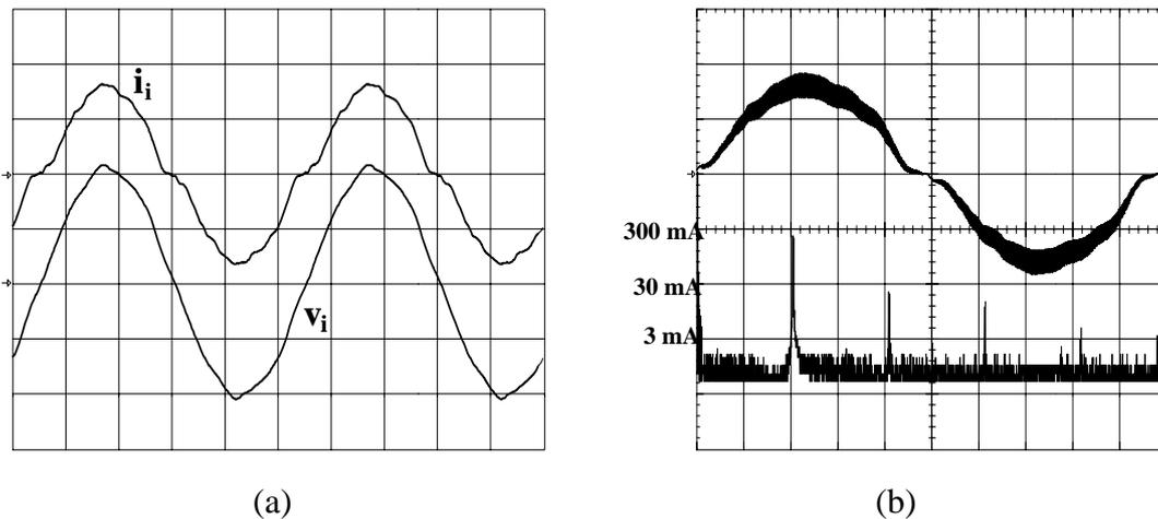
Figura 3.13 (a) Corrente (filtrada) e tensão de entrada.
