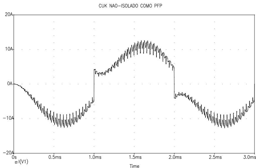
Figura 6.11 Corrente de entrada com capacitor C1 de baixo valor
