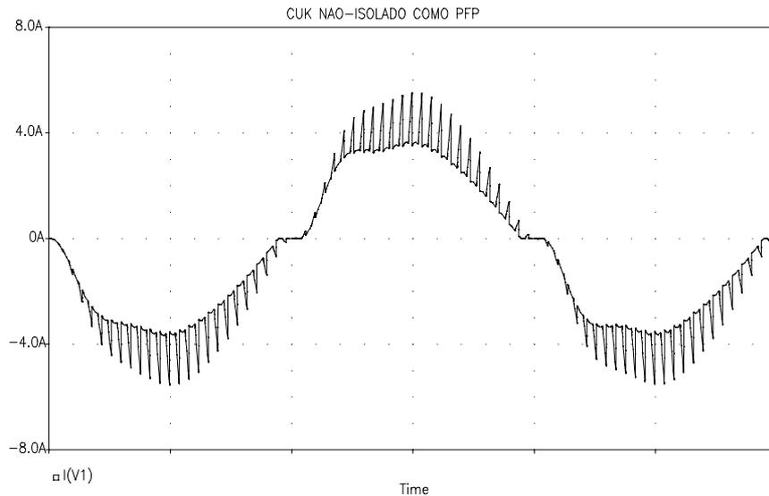
Figura 6.10 Corrente de entrada com capacitor C1 com valor muito elevado
