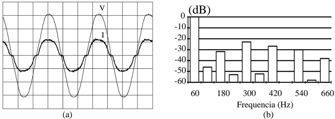
Figura 3.14 (a) Tensão (50 V/div.) e corrente de linha (5 A/div.). Horiz.: 5 ms/div.
