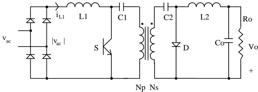
Figura 3.12 Conversor Cuk isolado, operando como PFP
