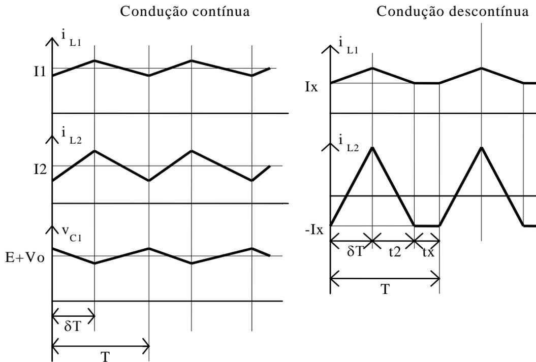
Figura 6.2. Formas de onda do conversor Cuk em condução contínua e descontínua
